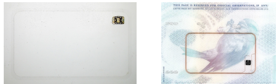
Obrázok 2. Bezkontaktný čip s tlačенou anténou a anténou vo forme medeného drôtu
